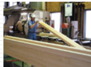
■切削 材料の面を平滑にし、 均一に接着剤塗布できるよう プレーナーをかけます
