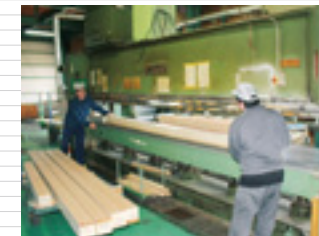
■プレス 接着剤塗布後、熱圧プレスにより 芯材に突板を圧着させます
